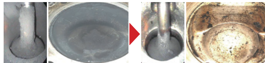
施工前 施工後
